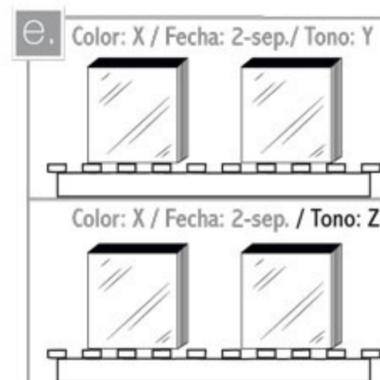
Agrupe las cajas de acuerdo a su tono, lote y fecha de fabricación. Compare visualmente las piezas para verificar la uniformidad de su superficie. Este proceso debe realizarse en exteriores y a la luz solar. Si instala referencias rústicas o marcadas con el sello ARTcoiris de impresión digital, combínelas para establecer homogeneidad en las vetas o los diseños.
