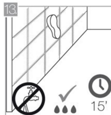
Retire los excesos de boquilla con una esponja humedecida en agua limpia antes de que se cumplan 15 minutos de su aplicación. No omita este paso, pues el contacto prolongado con el material de rejuntado ocasiona daños irreparables en la superficie de las piezas.
