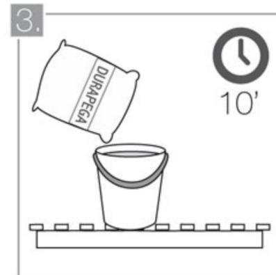
3. Prepare una cantidad de mortero de pega suficiente como para media hora de trabajo y déjela reposar por 10 minutos antes de iniciar su aplicación. El mortero de pega siempre debe ser preparado con agua limpia y en recipientes totalmente libres de impurezas. No combine una mezcla recién hecha con una ya reposada, pues esto reducirá su adherencia.
