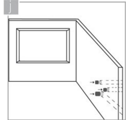
Recubra las campanas de desagüe y de los abastos de agua con papel o rollos de tela para evitar que restos de material de pega se acumulen en su interior.
