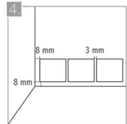
4. Mantenga una distancia mínima de 3 mm. entre las piezas y una junta perimetral de 8 mm. con respecto a los muros para prevenir un desprendimiento futuro del producto. En áreas extensas, instale los pisos en secciones de máximo 30 m<sup>2</sup>, dejando dilataciones perimetrales entre ellas. Si la superficie tiene juntas estructurales debe respetarlas. Recomendamos el uso de Sikaflex 1CSL o 1A para el llenado de estos espacios.
