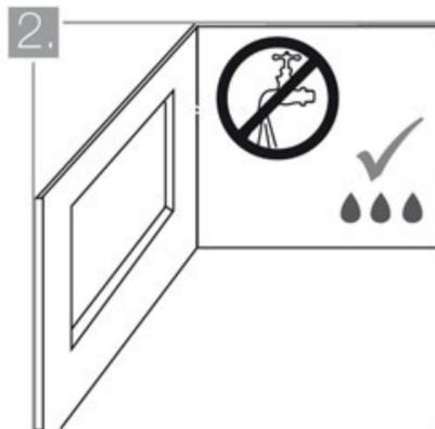
2. Sature de agua la superficie de soporte sobre la que instalará las cerámicas, de manera tal que permanezca húmeda durante la colocación.
