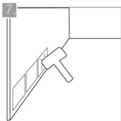
7. Adhiera cada pieza presionando levemente y girándola un poco hacia los lados. Golpee con el martillo de goma para evacuar restos de aire presentes en el material de pega. No instale en un patrón escalonado o de junta trabada, ya que esto puede generar desniveles. Utilice las crucetas de 3 mm. para crear una separación entre las piezas.
