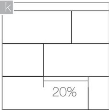
Realice la instalación de manera tal que la línea entre las piezas forme una cuadrícula. Si desea colocar los productos en un patrón escalonado o de 'junta trabada', hágalo de manera tal que la intersección entre las fichas no supere el 20% del lado total de la pieza.
