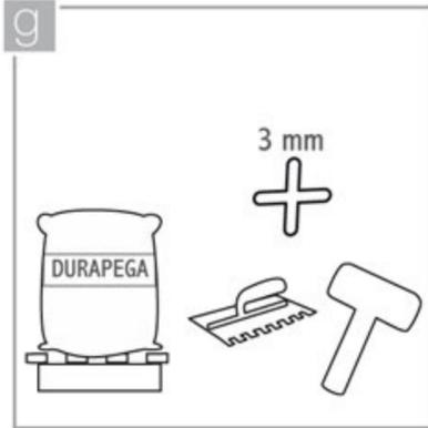
Asegúrese de que cuenta con los siguientes elementos antes de iniciar la instalación: mortero de pega, crucetas plásticas de 3 a 6 mm. de espesor de espesor, llana metálica de 6 mm. a 12 mm. (según el formato), martillo de goma color neutro, espátula de goma y cartón corrugado.
