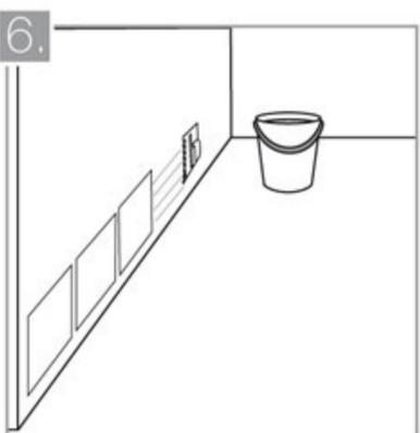
6. Esparza mortero de pega sobre un área equivalente a la de la pieza y cree surcos con la llana dentada. En formatos superiores a los 33 x 33 cms., repita el procedimiento en la cara oculta de la pieza. Adhiera la cerámica inmediatamente, ya que la exposición del pegamento al ambiente puede restar sus propiedades de adherencia.
