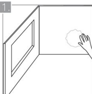
1. Antes de iniciar la instalación, lave la superficie de la pared con agua y un cepillo para eliminar el polvo y los residuos de obra, ya que estos restan adherencia al mortero de pega.
